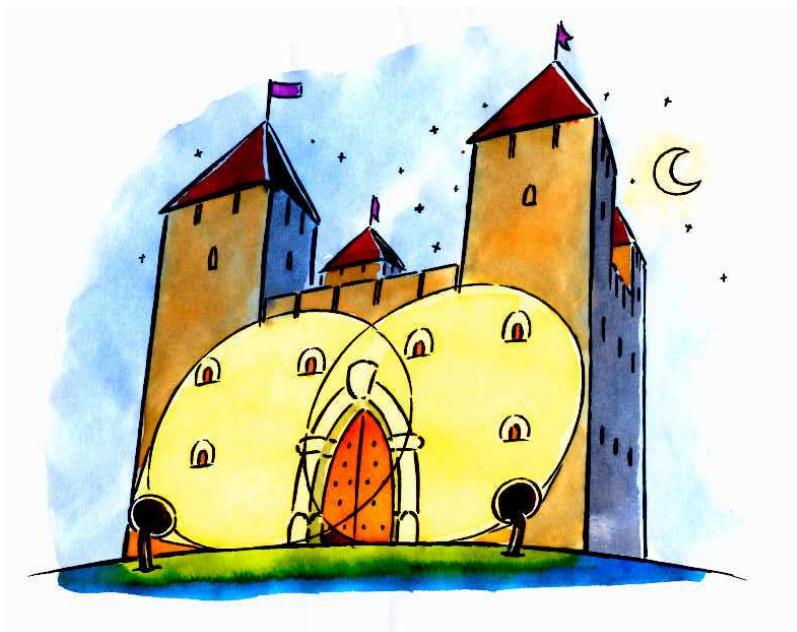
Fig. 5.12 - Corretta illuminazione dal basso di un edificio storico. Il flusso luminoso rimane contenuto entro la sagoma dell'edificio.
